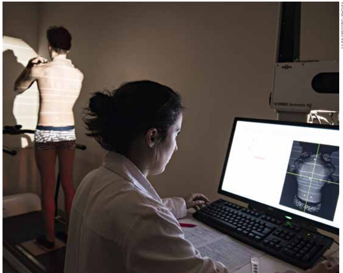
► Le système rasterstéréographique permet de modéliser la colonne vertébrale en 3D.
